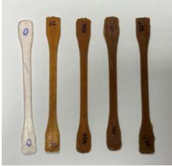
Şekil 1. Çekme deneyi için üretilen kompozit numunelerin fiziki görüntüleri
